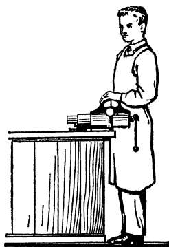
Рис. 85. Определение соответствия высоты слесарного верстака росту ученика.
