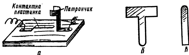
Рис. 62. Патрончик на подставке (а) и шаблоны для заготовок патрончика (б) и контактной пластинки (в).
