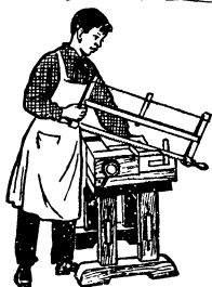
Рис. 97. Рабочая поза при пилении поперек волокон.
