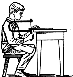
Рис. 18. Рабочая поза при работе лобзиком.
