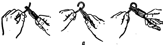
Рис. 55. Правка тонкой проволоки с помощью стержня, зажатого в тисках.
