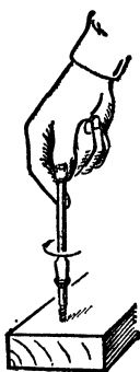
Рис. 36. Завинчивание шурупов отверткой.
