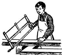
Рис. 96. Исправление направления пиления.
